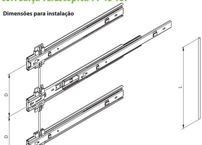
L= comprimento da barra de interligação D = distância entre corrediças
