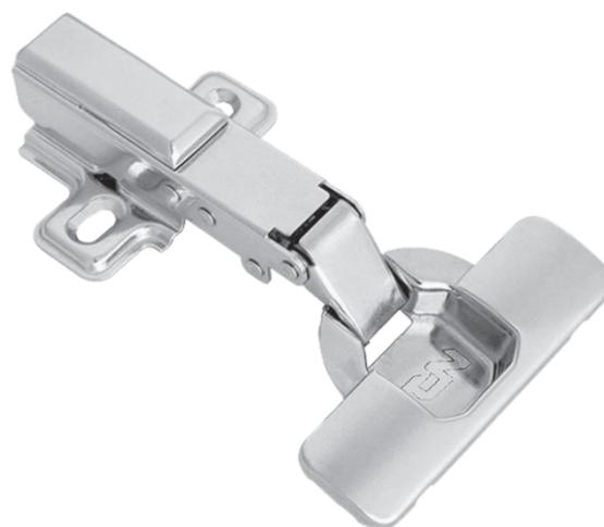
**Descrição:** Dobradiça com amortecedor incorporado para fechamento suave de portas. Produzida em aço inox 201 para aplicação em ambientes especiais. Sistema de montagem slide-on.
