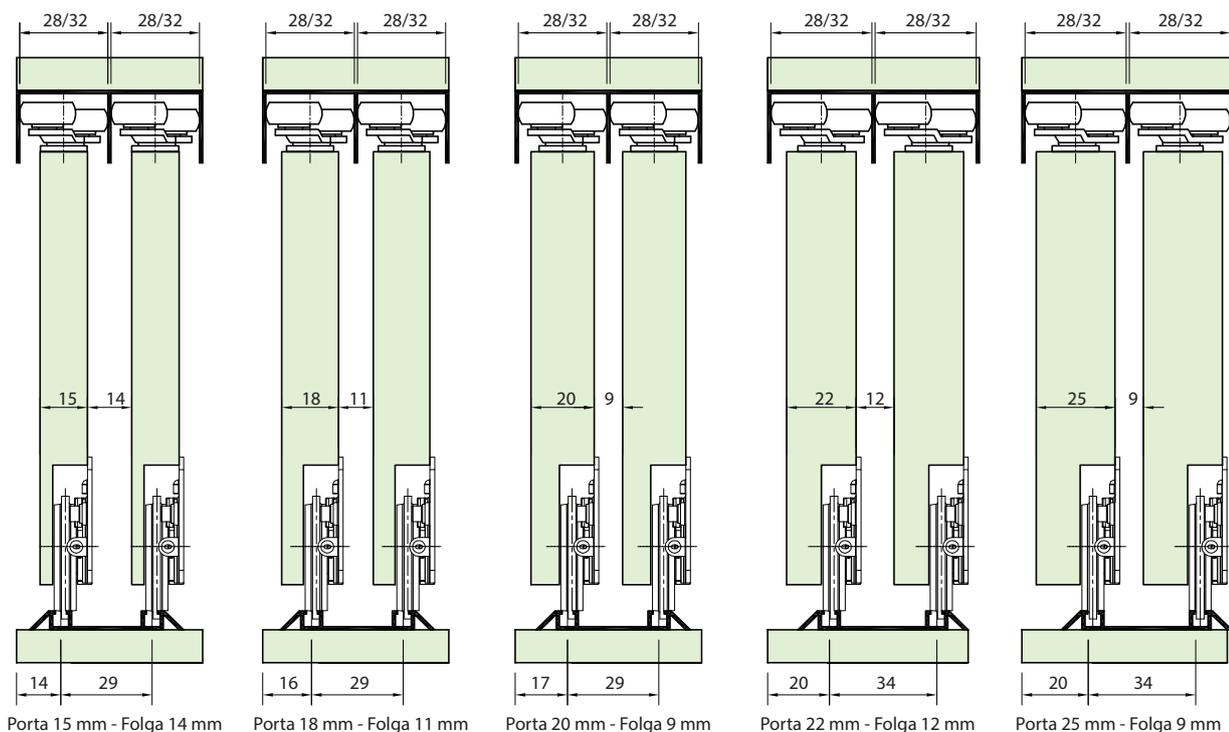
Instalação do batente freio no perfil
