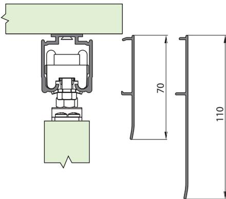
Usinagem da ranhura e fixação do perfil de alumínio na porta
