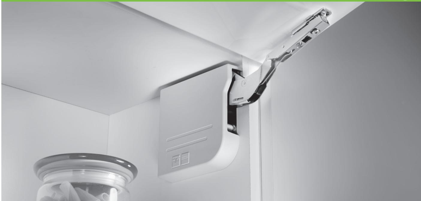
**Descrição:** Sistema compacto para abertura de portas verticais e que permite acesso total à parte interna do móvel. Com rápida fixação, dispensa a aplicação de dobradiças e possui sistema de amortecimento acoplado para ajustes precisos, com base no tamanho e peso da porta. É indicado para portas com altura máxima de 400mm, com largura variável e apresenta excelente custo/benefício. Possui estágios de abertura.
